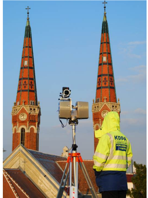
Laserscanneraufnahme für Schadensdokumentation und Planung der Renovierung der Kirche St. Karl Borromäus in Lainz, Wien,
