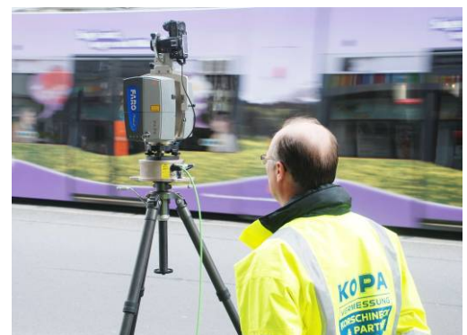
Laserscanning für Fassadenaufnahme
