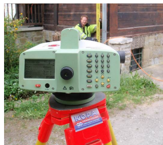
Vollelektronische Ablesung und Speicherung auf CF-Karte beim Messvorgang (automatischer Datenfluss)
