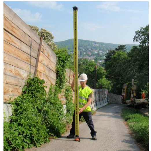
Präzisions-Nivellierlatte mit gespanntem Invarband
