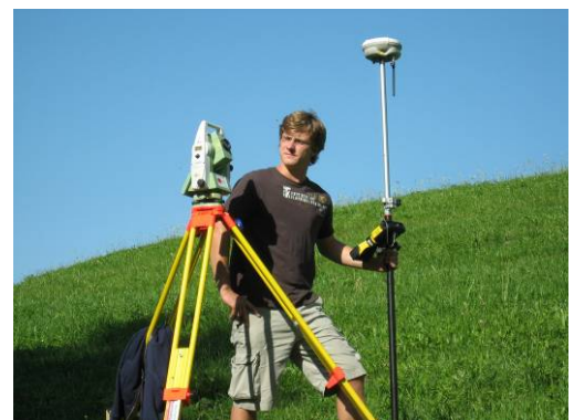
Grundlagenvermessung: RTK-GPS kombiniert mit konventioneller Vermessung mittels Totalstation
