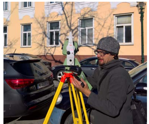
Tachymetrische Grundlagenvermessung mit 1-Personen-Station
