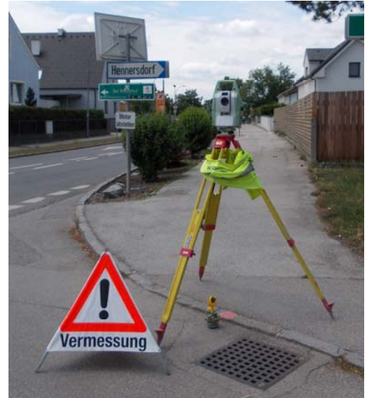
Tachymetrische Netzmessung mit Leica TM50 an der Pottendorfer Linie in NÖ
