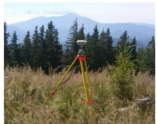
GPS-Vermessung eines Punktes des Grundlagennetzes am Geomagnetischen Observatorium Trafelberg (Conrad Observatorium), Niederösterreich
