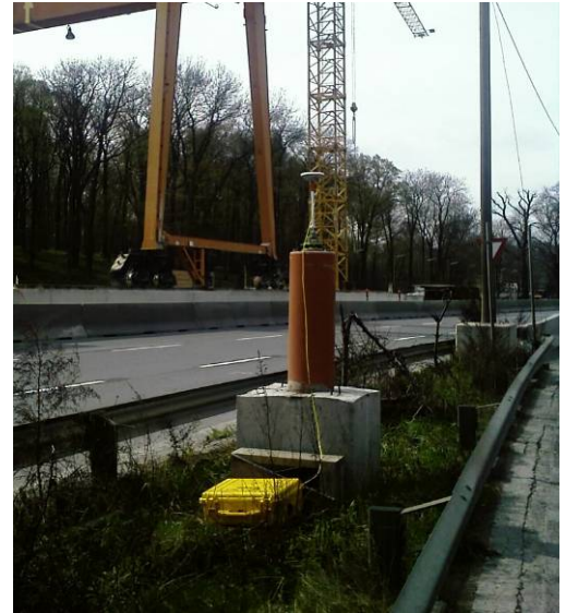
Satellitengestützte Einmessung eines Pfeilers des Grundlagennetzes am Lainzer Tunnel, Wien
