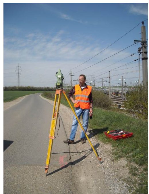
Netzvermessung mit ÖBB-Sicherungsposten an der Verbindungsspanne Ostbahn- Flughafenschnellbahn, Zentralstellwerk Wien-Kledering
