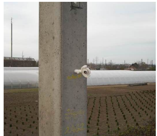
Typische Punktvermarkung für Netzmessungen im Gleisbereich auf Fahrleitungsmast, Verbindung Ostbahn- Flughafenschnellbahn, Wien-Kledering
